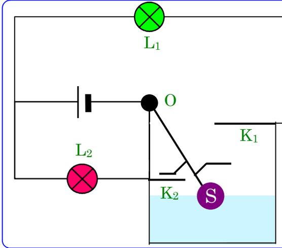
يتكون التركيب من جسم عائم (S) قاطعتين للتيار الكهربائي  $K_1$  و  $K_2$  ومصباح أخضر  $L_1$  ، مصباح أحمر  $L_2$  وساق معدنية OS قابلة للدوران حول O . إن هذا التركيب سيعينك على مراقبة مستوى الماء في الحوض .
