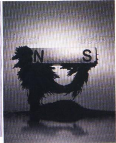
شكل - 1 : برادة الحديد تنجذب عند القطبين
