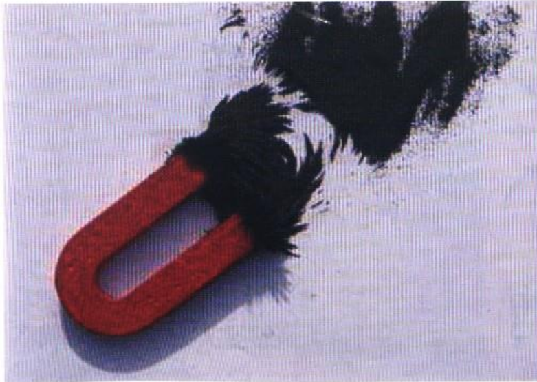
شكل - 2 : الآثار المغناطيسية تظهر عند القطبين
