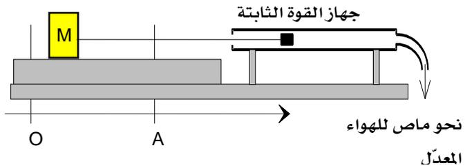
نشغل الجهاز ونترك المتحرك M بدون سرعة ابتدائية من النقطة O
