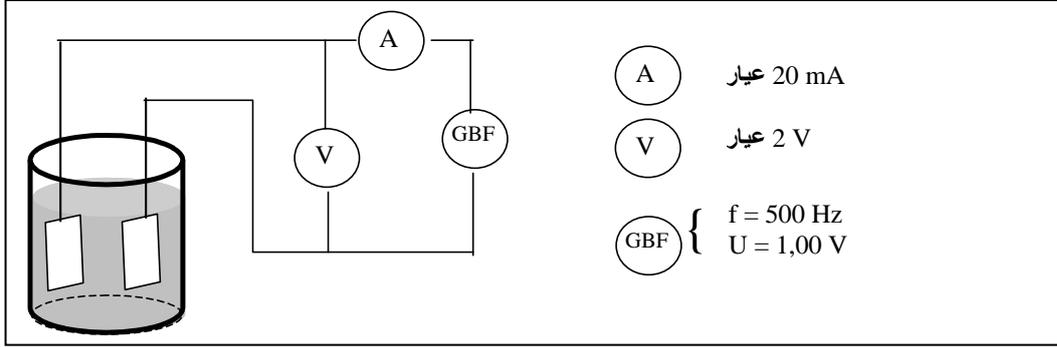
نستعمل GBF ونختار التيار المتناوب الجيبي (تواتره  $f = 500\text{Hz}$  ،  $U_{eff} = 1,00\text{V}$ ) من اجل منع استقطاب
