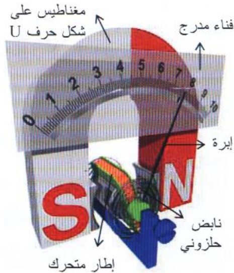
شكل - 7 : إطار متحرك لجهاز الأمبير متر.
