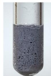
**2. La réaction entre le fer et l'acide chlorhydrique**, contenant des ions  $\text{H}^+$  et des ions  $\text{Cl}^-$ , a pour équation de réaction :
