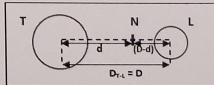
2<sup>ème</sup> méthode : Au point N on a donc  $g_T = g_L$ , soit :  $G \cdot \frac{M_T}{d^2} = G \cdot \frac{M_L}{(D-d)^2}$  et on trouve  $d = \frac{9}{10}D = \frac{9}{10}D_{T-L} = 345600 \text{ km}$ .
