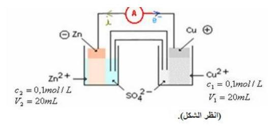
يمر التيار الكهربائي عبر الدارة الخارجية من صفيحة النحاس نحو صفيحة الزنك و الإلكترونات لها عكس منحى التيار الكهربائي ، أي تمر من صفيحة الزنك نحو صفيحة النحاس
