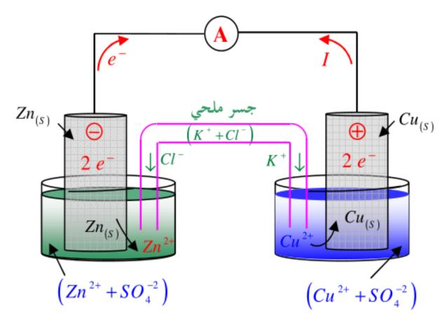
E القوة المحركة الكهربائية للعمود
