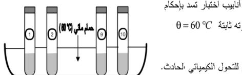
قسمنا المزيج بالتساوي على عشرة أنابيب اختبار تسد بإحكام  $\theta = 60 \, ^{\circ} C$  وتوضع في حمام مائي درجة حرارته ثابتة (الشكل-4).
