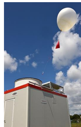
Figure 1 : lâcher de ballon automatique © Météo-France, Pascal Taburet
