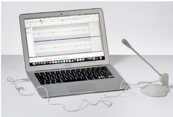
►► C'est le microphone qui transforme le signal sonore en signal électrique. L'ordinateur va convertir, au niveau de l'un de ses composants, le signal électrique en signal numérique.
