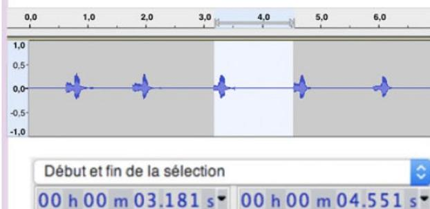
Grâce à l'outil réticule, on sélectionne une partie du signal pour en mesurer la **durée** avec précision.
