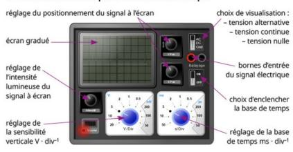
Il **se branche aux bornes d'un dipôle** (générateur ou récepteur) dont on veut observer le signal de la tension.
