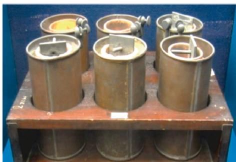
Figure 5. Photographie d'une batterie de piles Daniell
