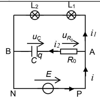
Dès que le condensateur est chargé,  $u_C = Cte$  donc  $\frac{du_C}{dt} = 0$ . Plus aucun courant électrique ne circule dans la branche AB ( $i_2 = 0$ ).
