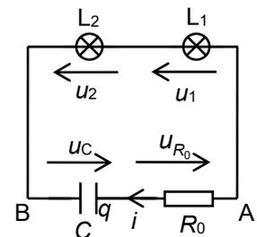
**(0,25)** Par définition,  $i = \frac{dq}{dt} = \frac{d(C.u_C)}{dt} = C \cdot \frac{du_C}{dt}$ , la capacité du condensateur étant une constante.
