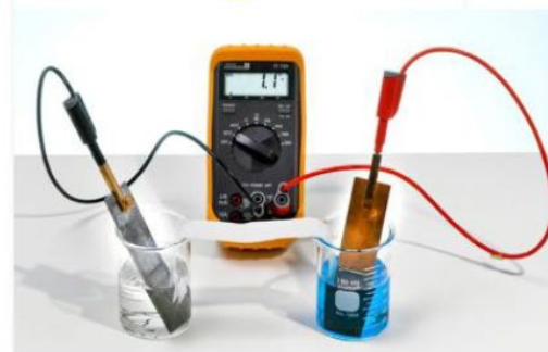
FIG. 5 Une pile cuivre-zinc. A Schématisation. B Réalisation au laboratoire.
