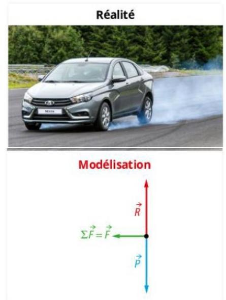
FIG. 8 Bilan des forces appliquées au centre de masse du système {voiture + chauffeur}.
