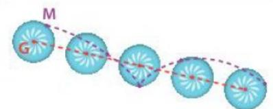
➤ Au cours du mouvement d'un frisbee, le centre de masse  $G$  a un mouvement plus simple que celui d'un point  $M$  à la périphérie.
