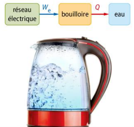
FIG. 4 W_e correspond à l'énergie reçue du réseau électrique par une bouilloire et Q l'énergie fournie à l'eau par celle-ci. Pour la bouilloire : W_e > 0 et Q < 0 .
