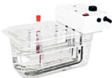
> Le bain-marie permet d'amener l'eau à la température souhaitée grâce à un chauffage homogène. Certains bains-marie peuvent porter l'eau à ébullition.
