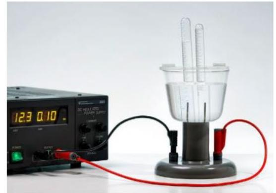
FIG. 4 Électrolyseur en cours de fonctionnement.
