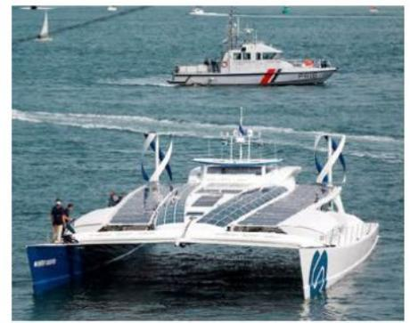
FIG. 5 Les panneaux solaires se trouvant sur le catamaran *Energy Observer* permettent de recharger les piles à combustible.
