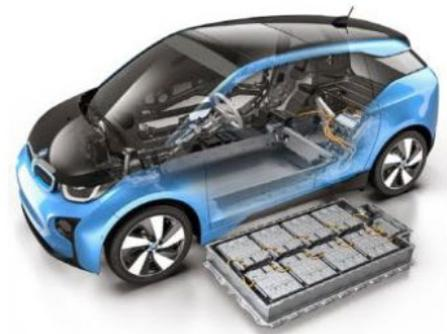
FIG. 6 Voiture électrique fonctionnant avec des batteries lithium-ion.
