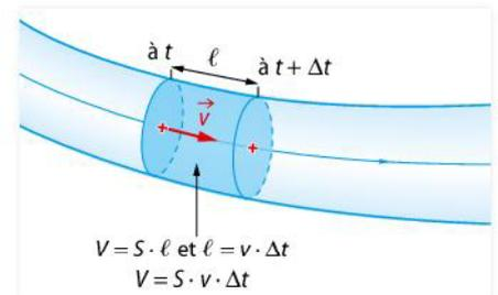
FIG. 5 Volume V et vitesse v d'un fluide traversant la section S d'un conduit.
