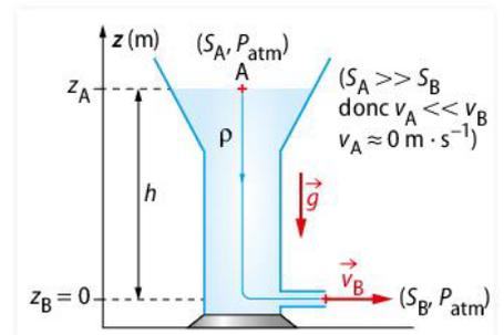
FIG. 9 La vitesse  $v_B$  de l'eau du robinet dépend de la hauteur d'eau  $h$  dans le château.
