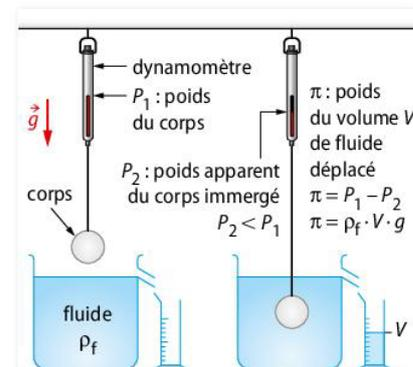
FIG. 3 La poussée d'Archimède  $\vec{\pi}$  est responsable du poids apparent  $P_2$  du corps immergé dans le fluide.
