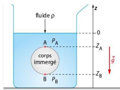
FIG. 1  $z_B < z_A$  donc  $P_B > P_A$ . La pression du fluide est plus importante en B qu'en A.
