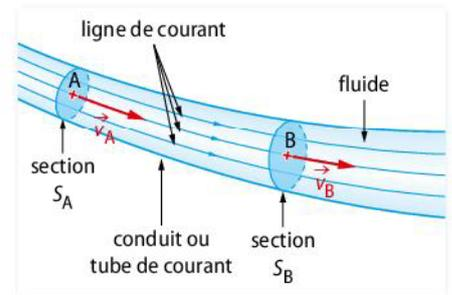
FIG. 4 Modélisation de l'écoulement d'un fluide incompressible.
