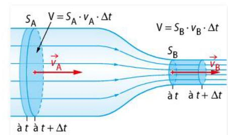
FIG. 6 Pendant une durée  $\Delta t$ , le même volume V de fluide traverse les sections  $S_A$  et  $S_B$ .
