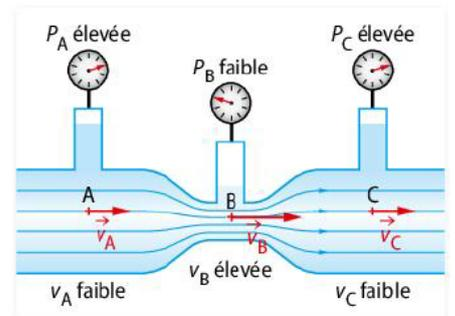
FIG. 10 Effet Venturi :  $v_B > v_A$  alors  $P_B < P_A$ .
