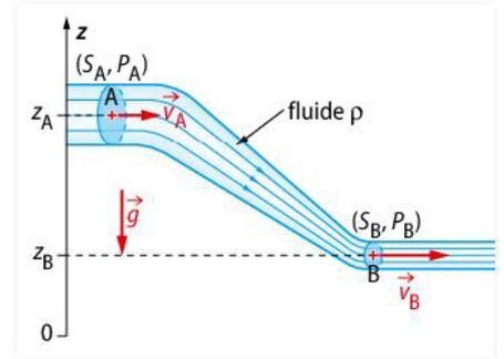
FIG. 8 En régime permanent, sur une même ligne de courant les grandeurs caractéristiques du fluide qui s'écoule ( $P$ ,  $\rho$ ,  $v$ ,  $z$ ) sont liées par la relation de Bernoulli.
