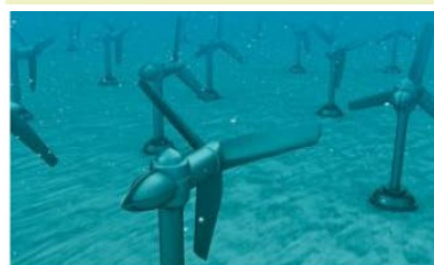
Fig. 3 : Exemple d'utilisation d'énergie renouvelable : projet de turbines hydrauliques utilisant l'énergie des courants sous la mer.
