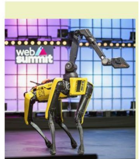
Fig. 4 : Spot, le chien robot de la société Boston Dynamics. Doté d'un bras dorsal, il est déjà utilisé pour explorer de façon autonome des zones dangereuses pour l'Homme.
