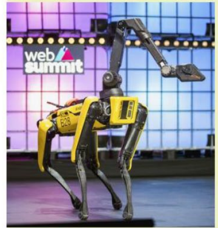
Fig. 4 : Spot, le chien robot de la société Boston Dynamics. Doté d'un bras dorsal, il est déjà utilisé pour explorer de façon autonome des zones dangereuses pour l'Homme.
